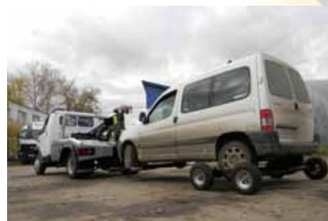
В случае, если одна из осей эвакуируемого ТС заблокирована, под нее легко подставляется подкатная тележка, которую может привести в рабочее состояние всего один водитель-оператор эвакуатора
