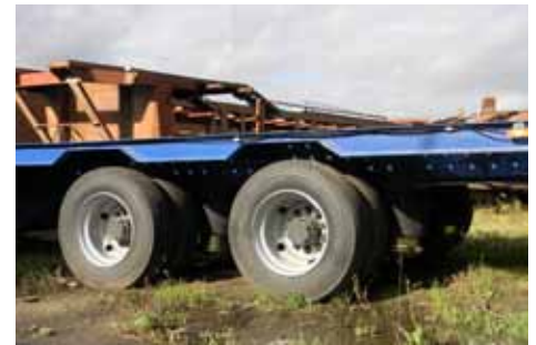
Собственная разработка компании «САРУС»: полуприцеп-тяжеловоз «САРУС-935024», предназначенный для перевозки грузов массой до 25 тонн
