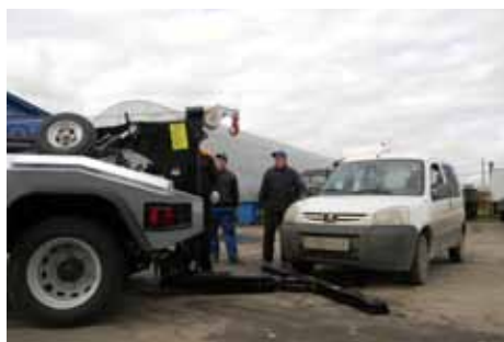
Эвакуатору-полупогрузу гораздо легче зацепить ТС в тесных городских условиях, чем платформенным эвакуаторам с полной погрузкой
